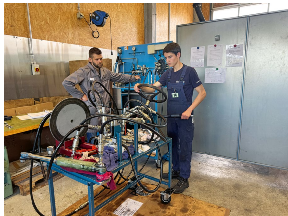
Florian Projer effectue – sous le regard de l'expert Urs Däscher – le contrôle de fonctionnement d'un système de direction hydraulique qu'il a lui-même monté.
