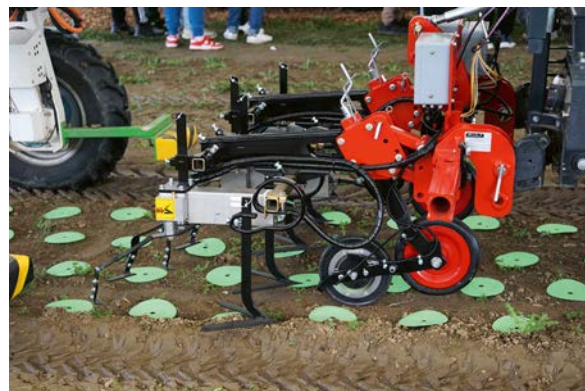
Der polyvalente «Orio» von Naïo Technologies wurde hier mit einem Präzisionshackgerät von K.U.L.T kombiniert.
