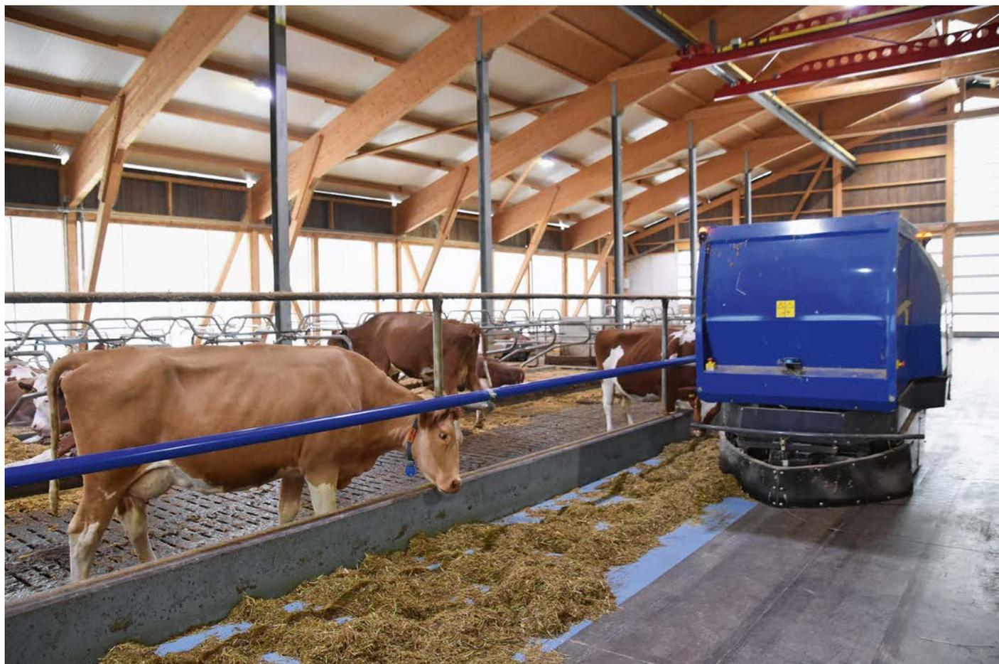
DeLaval: Der bodengeführte Verteilwagen ist gleichzeitig Zuschieber.
